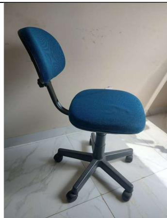
Patrimônio – 0345 Cadeira Giratória 4004 com rodas e estofado azul: Solda da base do encosto com acento cedendo, encosto já inclinado.
